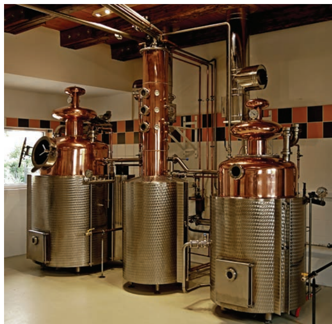
Lepárló berendezés üstjei
